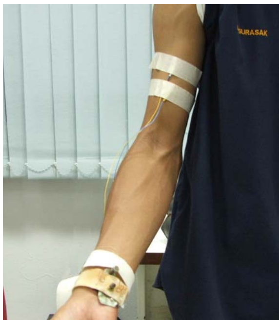
ภาพประกอบ 4-8 แสดงการติดอิเล็กโทรดบนแขนที่ต้องการวัดสัญญาณไฟฟ้าของกล้ามเนื้อลาย
