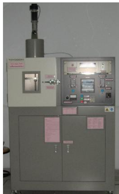
ภาพประกอบ 3.11 เครื่องทดสอบความต้านทานต่อโอโซน (ozone aging tester)
