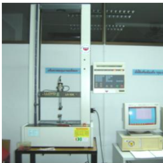
ภาพประกอบ 3.6 เครื่องทดสอบแรงดึง (tensometer)
