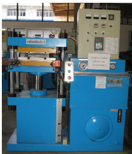
ภาพประกอบ 3.4 เครื่องอัดเบ้า (compression moulding)
