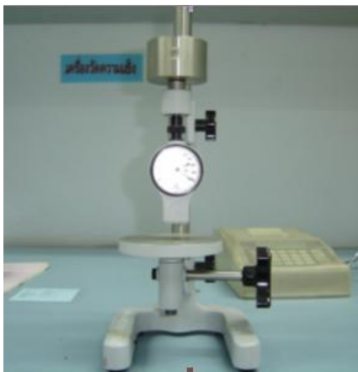
ภาพประกอบ 3.5 เครื่องวัดความแข็ง (hardness tester)
