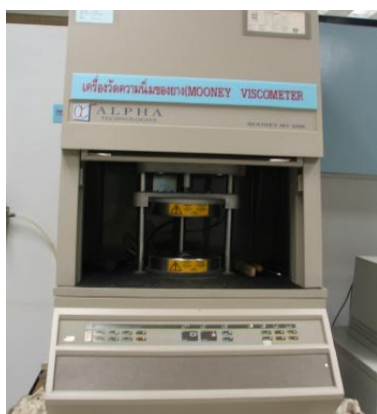
ภาพประกอบ 3.7 เครื่องทดสอบความหนืด (Mooney viscometer, MV2000) และ โรเตอร์ (rotor)
