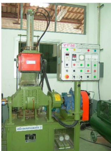
ภาพประกอบ 3.2 เครื่องผสมยางแบบปิด (Kneader)
