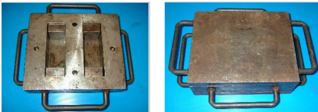
ภาพประกอบ 3.13 เป้ายางรองคอสะพานขนาดกว้างxยาวxหนา เท่ากับ 22x26x10 เซนติเมตร
