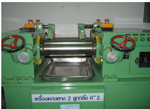
ภาพประกอบ 3.1 เครื่องบดยางสองลูกกลิ้ง (two roll mill)
