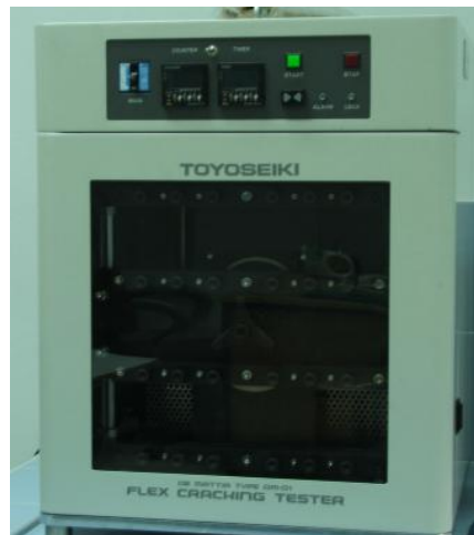
ภาพประกอบ 3.10 เครื่องทดสอบความต้านทานต่อการหักงอ (De Mattia flexing machine)
