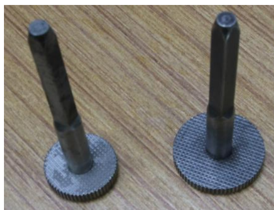
ภาพประกอบ 3.7 เครื่องทดสอบความหนืด (Mooney viscometer, MV2000) และ โรเตอร์ (rotor)
