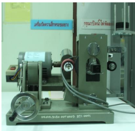
ภาพประกอบ 3.9 เครื่องทดสอบความต้านทานต่อการสึกหรอ (Akron machine)
