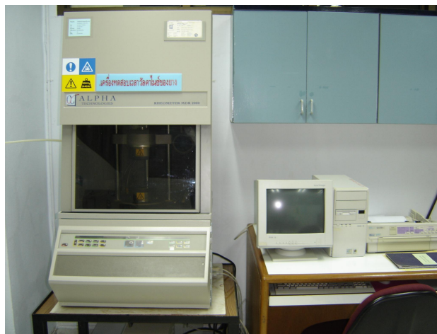
ภาพประกอบ 3.3 เครื่องทดสอบเวลาการวัดคาบในซ์ของยาง (Moving die rheometer, MDR 2000)
