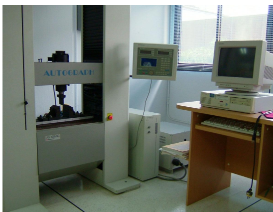
ภาพประกอบ 3.14 เครื่องวัดค่าแรงดึงของวัสดุ (universal testing machine)
