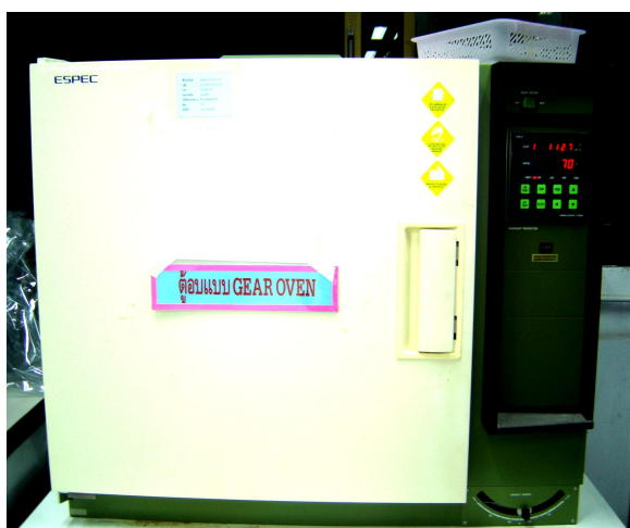
ภาพประกอบ 3.8 ตู้อบบ่มแรงชนิด Gear Aging
