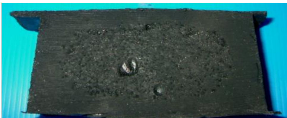
ภาพประกอบ 4.44 ลักษณะผิวภายในของยางรองคอสะพานที่ใช้เวลาในการอัด 30 นาที
