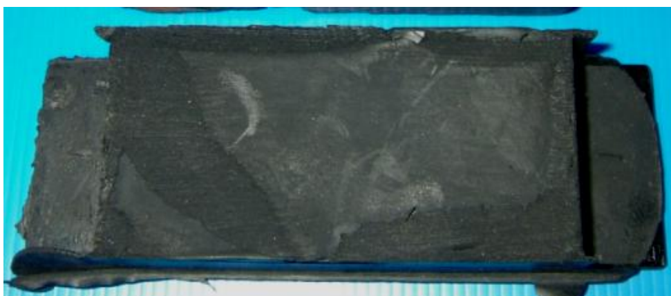
ภาพประกอบ 4.45 ลักษณะผิวภายในของยางรองคอสะพานที่ใช้เวลาในการอัด 40 นาที
