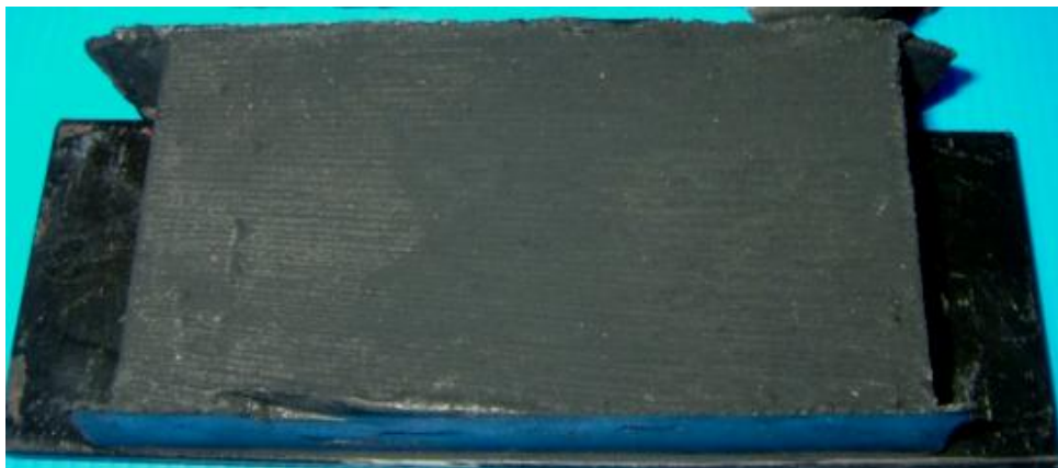
ภาพประกอบ 4.46 ลักษณะผิวภายในของยางรองคอสะพานที่ใช้เวลาในการอัด 50 นาที
