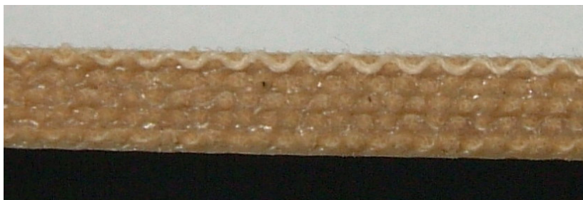
รูปที่ 4.51 ภาพตัดขวางของชั้นผ้าฝ้ายกับยางธรรมชาติ (สูตร Si10WR5)
