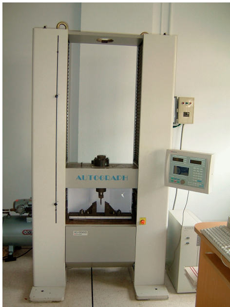
รูปที่ ก.3 เครื่องทดสอบแรงดึงและตัดโค้งรุ่น AG –100kN
