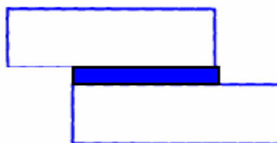
ภาพประกอบ 2.6 Lab/Overlap Joint
