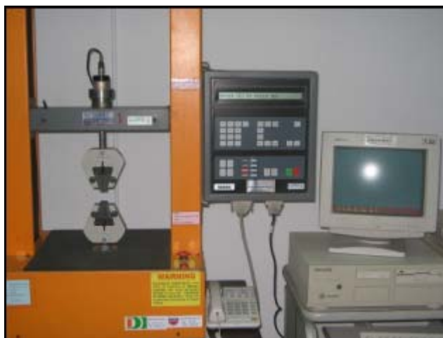
ภาพประกอบ 3.1 เครื่องทดสอบความทนต่อแรงดึง
