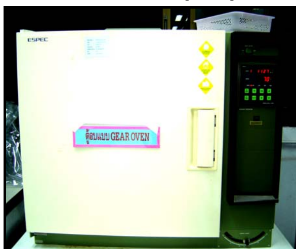
ภาพประกอบ 3.15 ตู้อบบ่มเร่งชนิด gear aging
