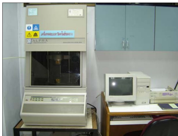
ภาพประกอบ 3.5 เครื่องทดสอบเวลาการวัลคาไนซ์ของยาง
