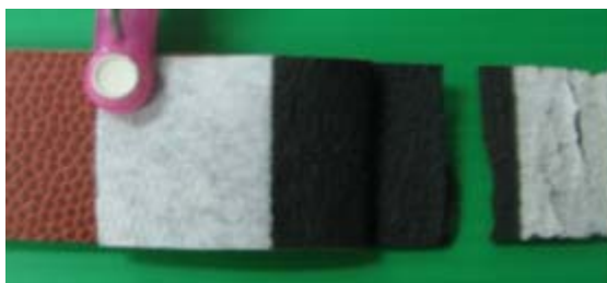
ภาพประกอบ 4.6 ลักษณะการล้มหเลวของการยึดติดโดยขนาดก่อนการดึงลอก
