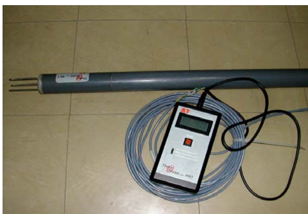
ภาพผนวกที่ 12 เครื่องวัดความชื้นในดิน
