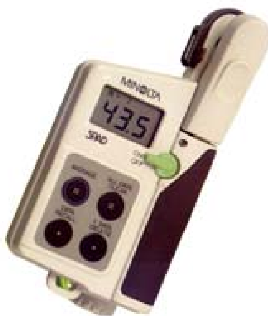
ภาพที่ 1 แสดงเครื่องมือคลอโรฟิลล์มิเตอร์ (SPAD-502)
