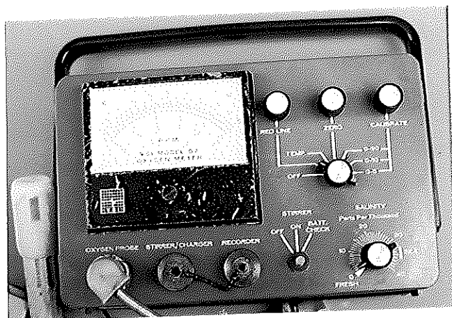
ภาพผนวกที่ 1 เครื่องวัดปริมาณออกซิเจนที่ละลายในน้ำ ( Oxygen Meter YSI Model 57 )
