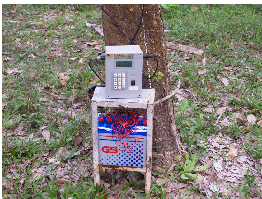
ภาพที่ 3 การติดตั้งอุปกรณ์การวัดอัตราการไหลของน้ำในลำต้น (Sapflow sensor) รุ่น PSU-NRC ของต้นยางพาราในแปลงทดลอง
