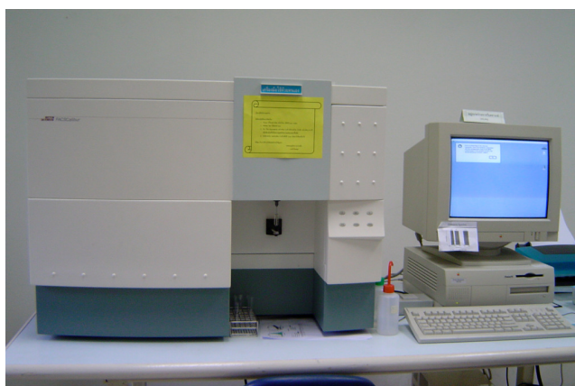
ภาพที่ 3 เครื่องวัดปริมาณดีเอ็นเอ FACScalibur Flow Cytometer (Beckton Dickinson)
