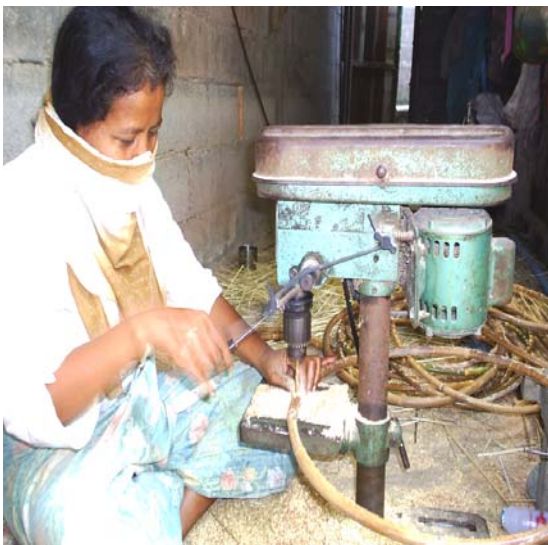
การเจาะรูหวายด้วยเครื่องจักรไฟฟ้าที่ชำรุด
