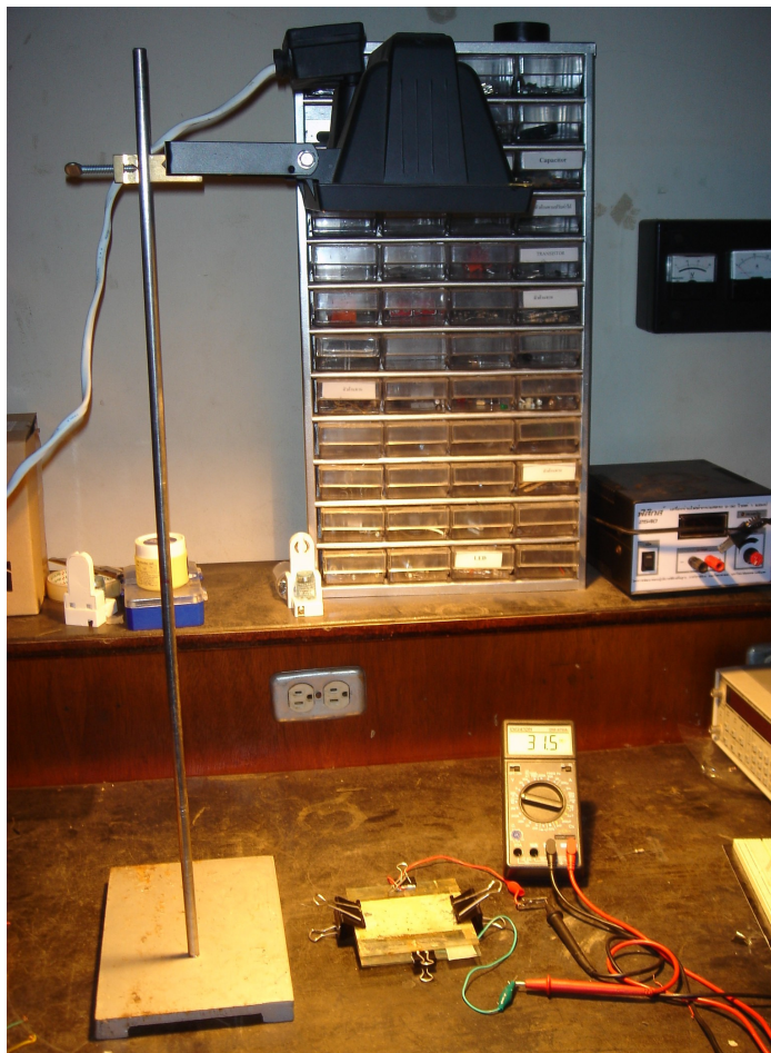
ภาพประกอบที่ 4-8 การวัดค่าแรงดันไฟฟ้าวงจรเปิดที่ค่าการส่องสว่างที่ 1,000 Lux
