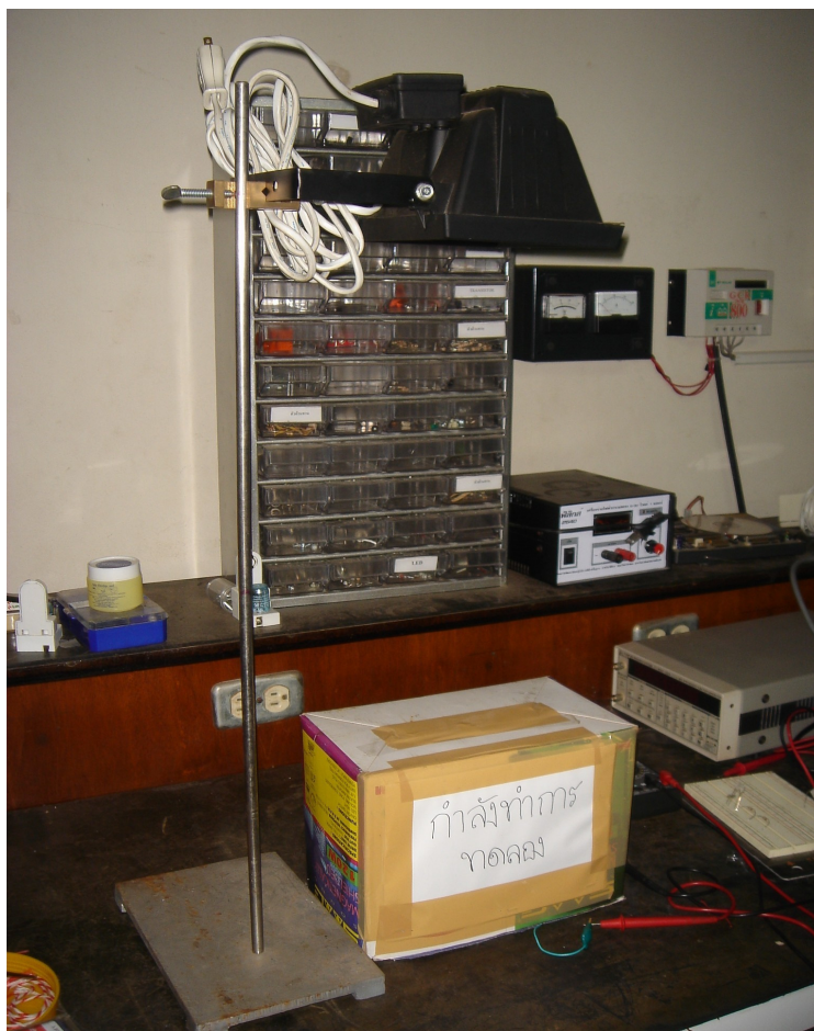
ภาพประกอบที่ 4-9 การวัดค่าแรงดันไฟฟ้าวงจรเปิด ภายใต้ ค่าการส่องสว่าง 0 Lux
