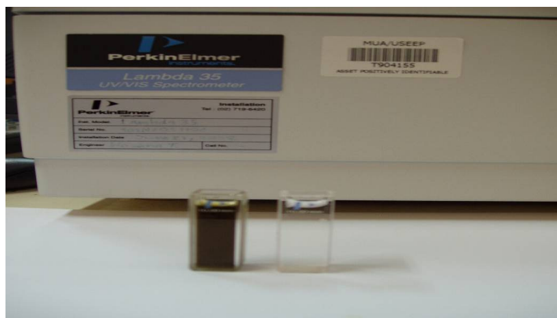
ภาพประกอบที่ 4-2 UV/Vis Spectrophotometer และลักษณะของสารละลายคลอโรฟิลล์
