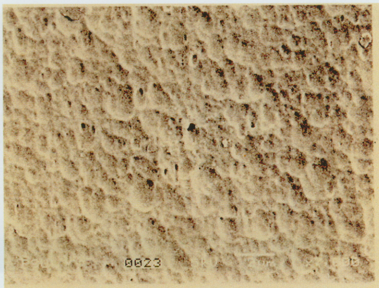
ภาพประกอบ 59 แสดงภาพถ่าย SEM ที่กำลังขยาย 2,000 เท่า ระบุถึงผิวของอนุภาคแอลฟานาน 60 นาที ที่คักขยายรอยนาน 15 นาทีที่ด้านหน้า
