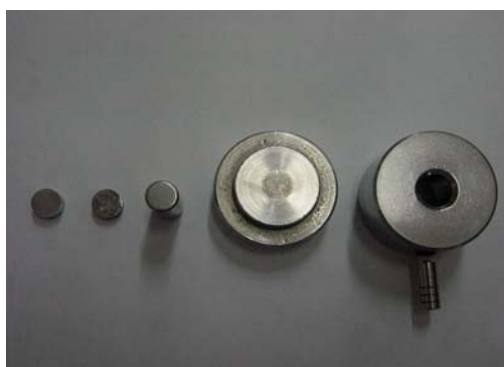
ภาพประกอบที่ 3.3 เบ้าอัดขึ้นรูปจี้แก้วเคลือบ
