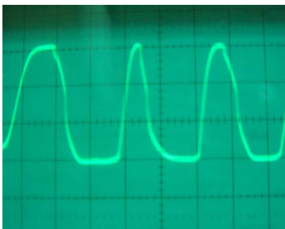
ภาพประกอบที่ 4.11 แสดงภาพบนจอออสซิลโลสโคป เป็นสัญญาณจากหัววัดแสงเมื่อมีการส่งกระจกอ้างอิงเพียงอย่างเดียวในขณะที่วงจรป้อนสัญญาณย้อนกลับกำลังทำงาน ในภาพ V_{p-p} ขณะที่ถูกควบคุมด้วยวงจรป้อนสัญญาณย้อนกลับ แอมพลิจูดของสัญญาณในภาพ คือ V_{p-p} มีค่า 0.3 V โดยประมาณ
