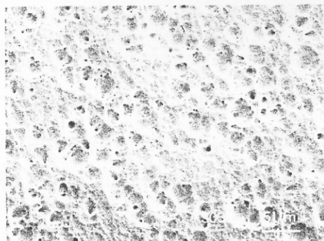
รูปที่ 4.39 แสดงภาพถ่ายจาก SEM 3,000X เส้นใยคาร์บอน NaOH 4.25 N อุณหภูมิ 85 °C เวลา 75 นาที
