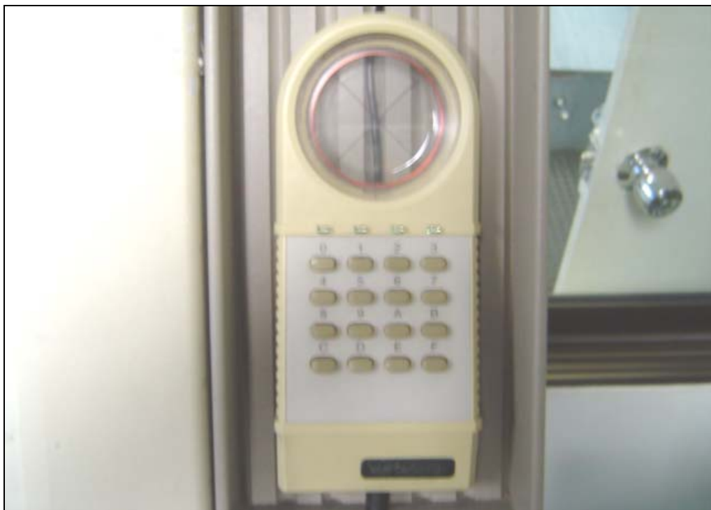
รูปที่ 3.7 อุปกรณ์ Digitizer ใช้คัดลอกแผนที่ลงในโปรแกรมคอมพิวเตอร์
