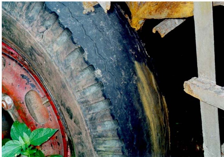
ภาพประกอบ 5.8 สภาพของดอกยางล้อหน้าของรถที่เกิดอุบัติเหตุกม. 27+650 ทางหลวงหมายเลข 203 ช่วงควบคุม 400 ตอน กม.30+000-สามแยกหน้าแขวงการทางเลยที่ 1
