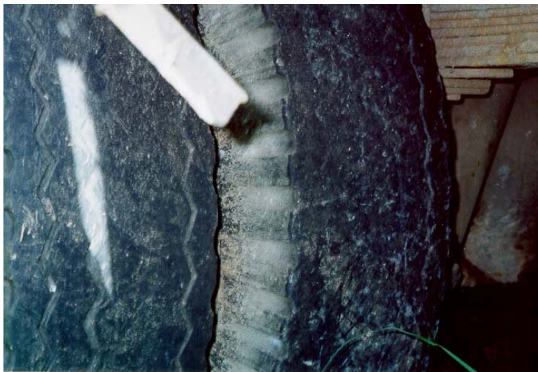
ภาพประกอบ 5.9 สภาพดอกยางของล้อหลังของรถที่เกิดอุบัติเหตุ กม. 27+650 ทางหลวงหมายเลข 203 ช่วงควบคุม 400 ตอน กม.30+000-สามแยกหน้าแขวง การทางเลยที่ 1
