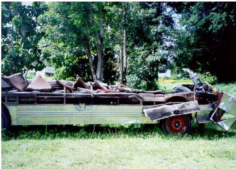
ภาพประกอบ 5.13 สภาพหลังคาของรถโดยสารที่ฉีกขาดที่เกิดอุบัติเหตุ กม. 27+650 ทางหลวงหมายเลข 203 ช่วงควบคุม 400 ตอน กม.30+000-สามแยกหน้าแขวงการทางเลยที่ 1
