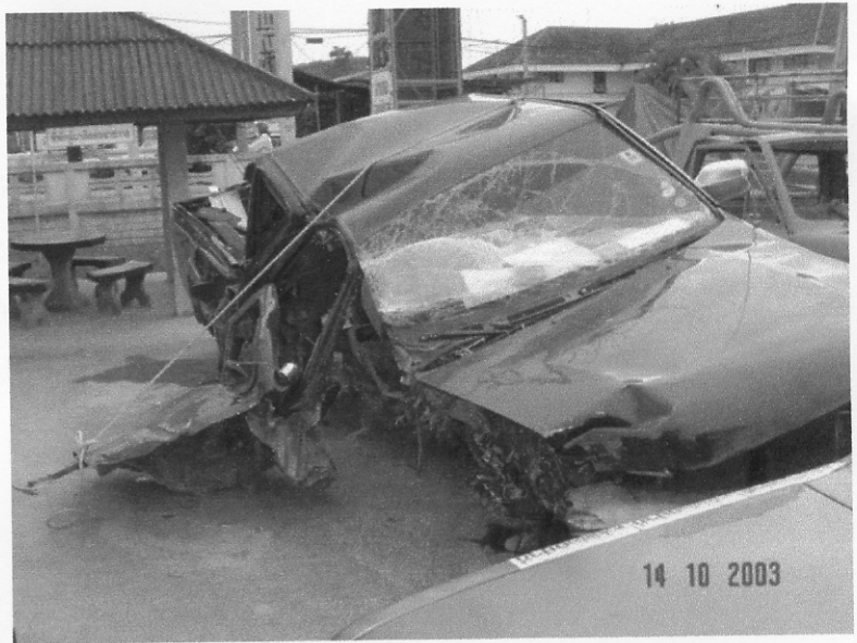
ภาพประกอบ 4.34 สภาพความเสียหายของรถที่เกิดอุบัติเหตุชนคอสะพาน
