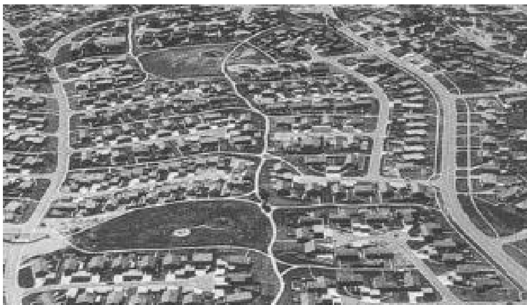
รูปที่ 2.3 แสดงโครงข่ายถนนท้องถิ่นที่ได้รับการออกแบบอย่างดีที่ได้แยกถนนที่เอื้ออำนวย ต่อความคล่องตัวในการเดินทางกับถนนสำหรับการเข้า-ออกพื้นที่ชัดเจน ที่มา : สำนักงานนโยบายและแผนการขนส่งและจราจร, 2547 ๗
