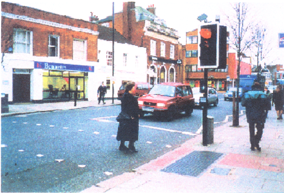
ภาพประกอบ ข - 6 ตัวอย่างการติดตั้งทางข้ามแบบฟิฟฟัน
