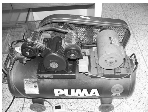
ภาพประกอบที่ 3.13 เครื่องปั๊มลมเพื่อให้แรงดันแก่เครื่อง Burst Test
