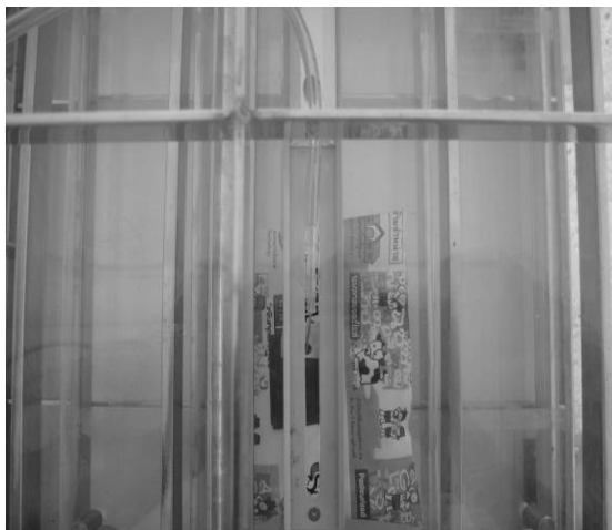
ภาพประกอบที่ 3.18 มุมมองจากด้านบนของถุงนมเมื่ออยู่ในเครื่อง Burst Test
