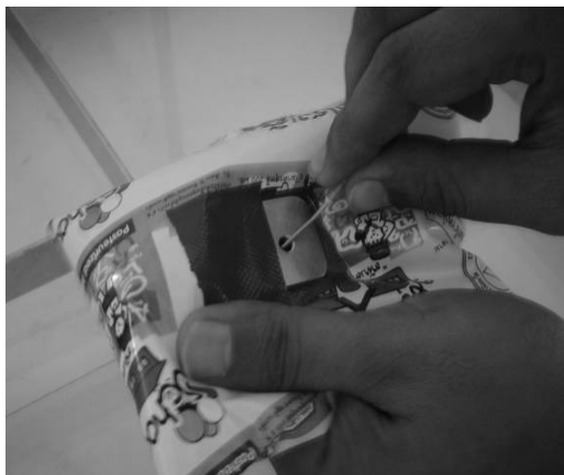
ภาพประกอบที่ 3.16 การเจาะรูบนเมมเบรนเพื่อป้อนแรงดันเข้าไป
