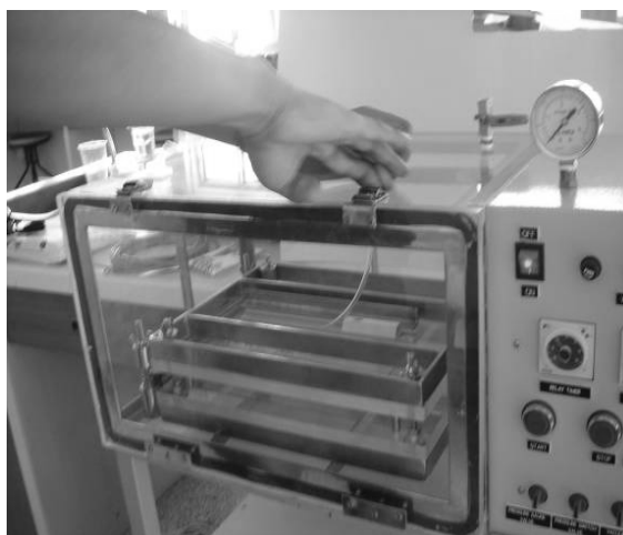
ภาพประกอบที่ 3.17 การปิดฝาเครื่องก่อนทำการกดปุ่มทดสอบ
