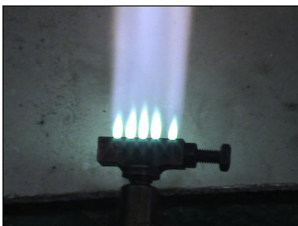
รูปที่ 2.10 แสดงเปลวแบบไฟออกซิไดซิง
