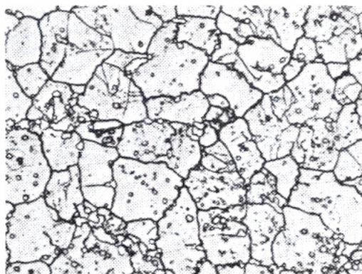
รูปที่ 2.2 แสดงโครงสร้างเหล็กสเตนเลสชนิดออสเทนนิติก
