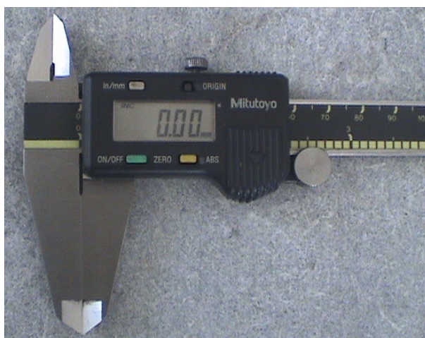
รูปที่ 3.7 แสดงเครื่องมือที่ใช้ในการวัดขนาดเส้นผ่านศูนย์กลางชิ้นงาน
