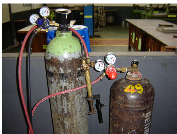
รูปที่ 3.5 แสดงอุปกรณ์ให้ความร้อนกับพื้นผิวชิ้นงาน
