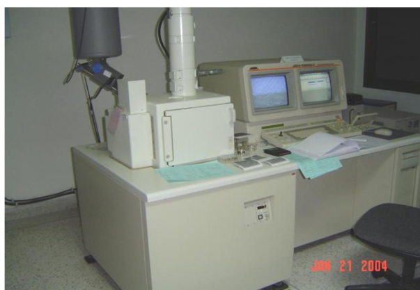
รูปที่ 3.9 แสดงกล้องจุลทรรศน์อิเล็กตรอน SEM
