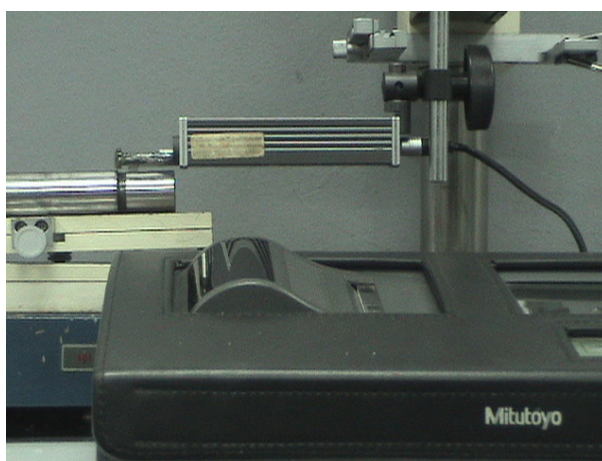
รูปที่ 3.14 แสดงการวัดค่าความขรุขระของพื้นผิวชิ้นงาน
