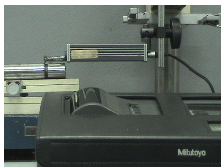
รูปที่ 3.17 แสดงการวัดค่าความขรุขระของพื้นผิวชิ้นงาน
