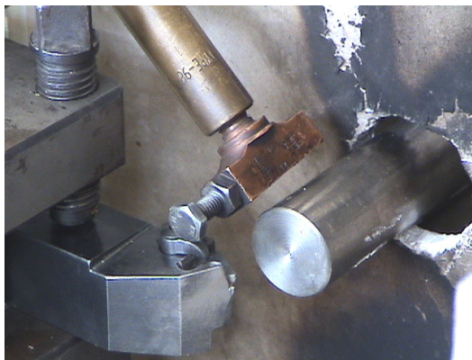
รูปที่ 3.11 แสดงการติดตั้งชุดให้ความร้อนบนป้อมมีดของเครื่องกลึง
