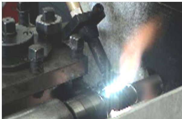
รูปที่ 3.12 แสดงการเริ่มต้นให้ความร้อนกับพื้นผิวของชิ้นงาน
