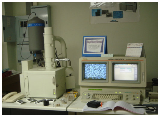
ภาพประกอบที่ 3.8 กล้องจุลทรรศน์อิเล็กตรอน
