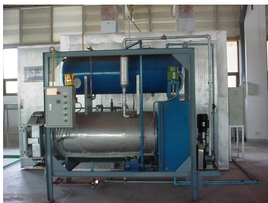
ภาพประกอบที่ 4.3 ชุดอุปกรณ์อบน้ำยาไม้ ขนาด 350 ลิตร
