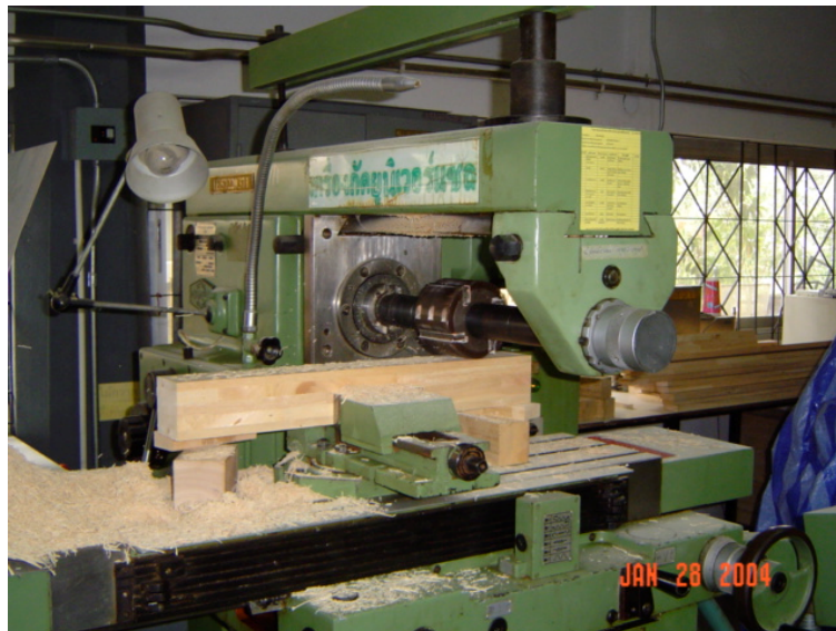
ภาพประกอบที่ 3.5 แสดงเครื่องกัด Universal Milling Machine
