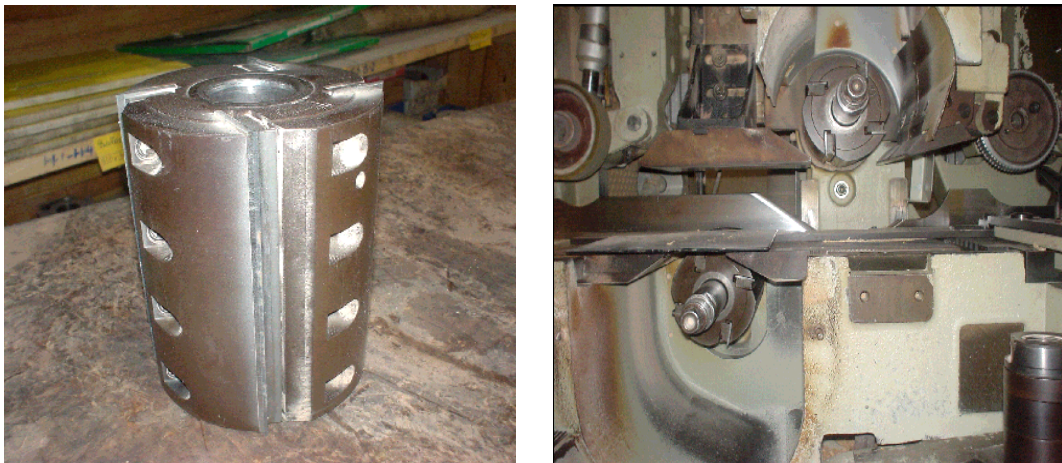
ภาพประกอบที่ 3.3 แสดงกะโหลกและตำแหน่งจับยึดกะโหลกในเครื่องไสสี่หน้า
