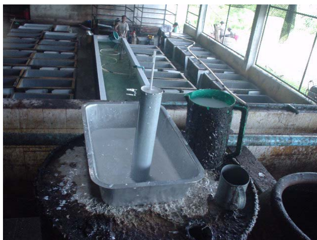
ภาพที่ 6 การหาความเข้มข้นด้วยเครื่องมือวัดความเข้มข้นของน้ำยาง
