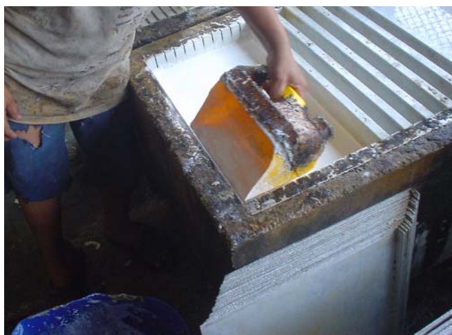
ภาพที่ 7 ตักฟองออกไปให้หมด ป้องกันไม่ให้เกิดรอยตำหนิในแผ่นยาง
