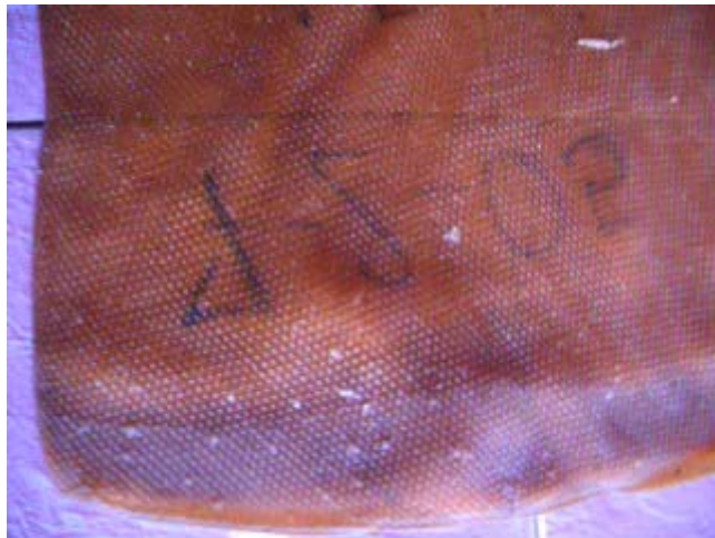
ภาพที่ 12 ยางฟอง ลักษณะเกิดเป็นฟองอากาศภายในเนื้อยางกระจายทั่วทั้งแผ่น
