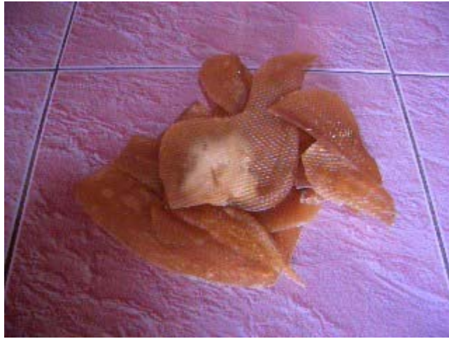
ภาพที่ 11 ยางคัตติ้ง คือรอยตำหนิต่างๆที่ตัดออกมาจากแผ่นยาง
