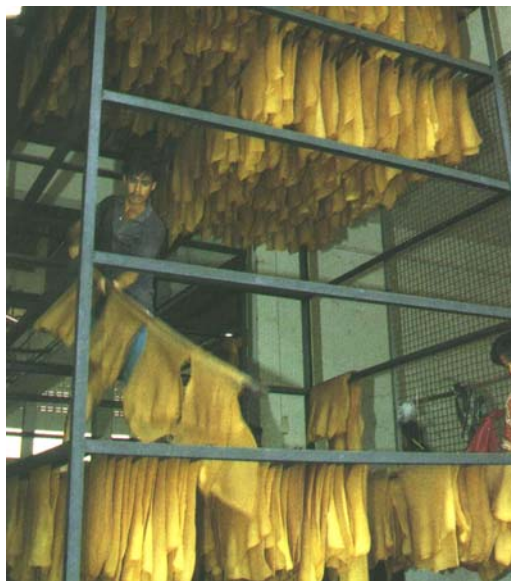
ภาพที่ 9 เก็บยางแผ่นที่รมสุกแล้วเพื่อนำไปคัดชั้นคุณภาพ
