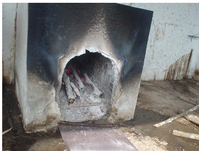
ภาพที่ 24 ประตูหน้าต่างชำรุดเสียหาย ทำให้สูญเสียความร้อน
