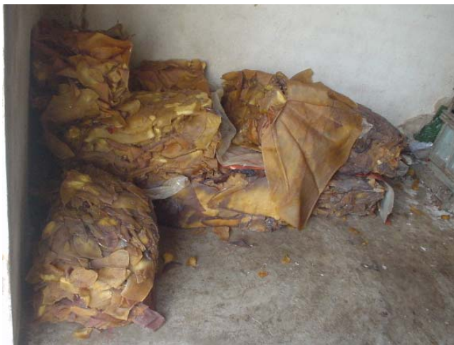
ภาพที่ 13 ยางคัตติง คือรอยตำหนิต่างๆที่ตัดออกมาจากแผ่นยาง
