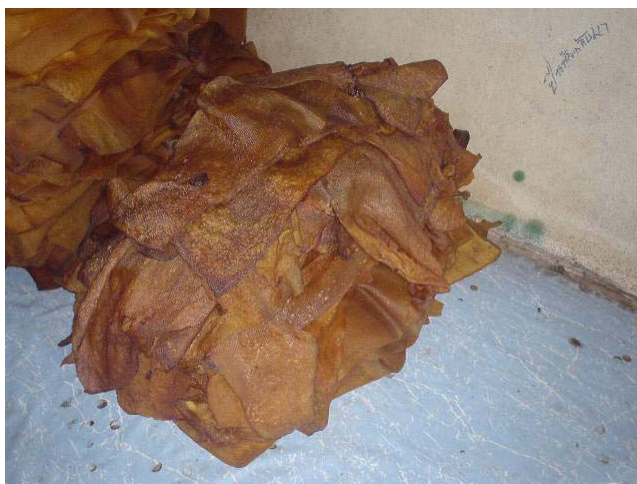
ภาพที่ 14 ยางฟอง ลักษณะเกิดเป็นฟองอากาศภายในเนื้อยางกระจายทั่วทั้งแผ่น
