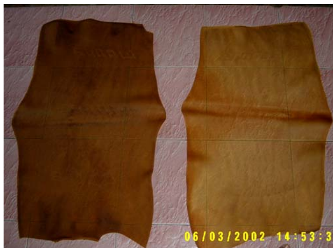
ภาพที่ 47 ยางที่ตากนอกโรงรม (ซ้าย) เทียบกับยางที่ตากในโรงรม (ขวา)
