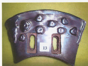
ภาคผนวก ง 6 ใบผสมดินเชื่อมพอกแข็งลายแนวเชื่อมแบบวงกลมหลังการใช้งาน (ผลิตอิฐดินเผาได้ 3,888,000 ก้อน)
