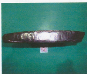
ภาคผนวก ง 18 ไบผสมดินเชื่อมพอกแข็งด้วยลวดเชื่อม E10-UM-65 (ผลิตภัณฑ์ A) ลายแนว เชื่อมแบบตาข่ายหลังการใช้งาน (ผลิตอิฐดินเผาได้ 3,888,000 ก้อน)
