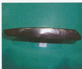
ภาคผนวก ง 14 ใบผสมดินเชื่อมพอกแข็งด้วยลวดเชื่อม E6-UM-55 (ผลิตภัณฑ์ A) ลายแนว เชื่อมแบบตาข่ายหลังการใช้งาน (ผลิตอิฐดินเผาได้ 3,888,000 ก้อน)
