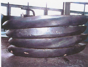
ภาคผนวก ง 2 ไบผสมดินยังไม่ได้เชื่อมพอกแข็งหลังการใช้งาน
