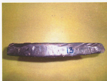
ภาคผนวก ง 6 ใบผสมดินเชื่อมพอกแข็งลายแนวเชื่อมแบบวงกลมหลังการใช้งาน (ผลิตอิฐดินเผาได้ 3,888,000 ก้อน)
