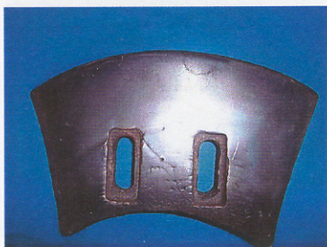
ภาคผนวก ง 1 ไบผสมดินยังไม่ได้เชื่อมพอกแข็งก่อนการใช้งาน
