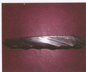
ภาคผนวก ง 20 ไบผสมดินเชื่อมพอกแข็งด้วยลวดเชื่อม E21-UM-65 ลายแนวเชื่อมแบบ ตาข่ายหลังการใช้งาน (ผลิตอิฐดินเผาได้ 3,888,000 ก้อน)
