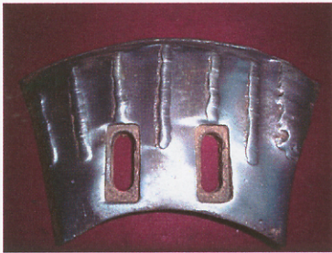
ภาคผนวก ง 10 ไบผสมดินเชื่อมพอกแข็งลายแนวเชื่อมแบบขีดหลังการใช้งาน (ผลิตอิฐดินเผาได้ 3,888,000 ก้อน)
