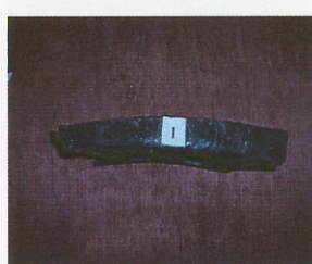
ภาคผนวก ง 15 ใบผสมดินเชื่อมพอกแข็งด้วยลวดเชื่อม E10-UM-65 (ผลิตภัณฑ์ B) ลายแนวเชื่อมแบบตาข่ายก่อนการใช้งาน
