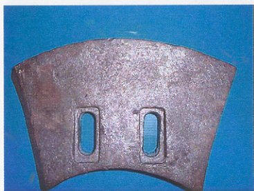
ภาคผนวก ง 1 ไบผสมดินยังไม่ได้เชื่อมพอกแข็งก่อนการใช้งาน
