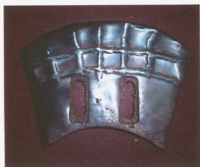
ภาคผนวก ง 20 ไบผสมดินเชื่อมพอกแข็งด้วยลวดเชื่อม E21-UM-65 ลายแนวเชื่อมแบบ ตาข่ายหลังการใช้งาน (ผลิตอิฐดินเผาได้ 3,888,000 ก้อน)
