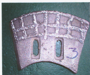
ภาคผนวก ง 19 ไบผสมดินเชื่อมพอกแข็งด้วยลวดเชื่อม E21-UM-65 ลายแนวเชื่อม แบบตาข่ายก่อนการใช้งาน
