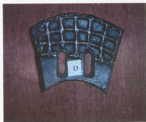
ภาคผนวก ง 17 ไบผสมดินเชื่อมพอกแข็งด้วยลวดเชื่อม E10-UM-65 (ผลิตภัณฑ์ A) ลายแนวเชื่อมแบบตาข่ายก่อนการใช้งาน
