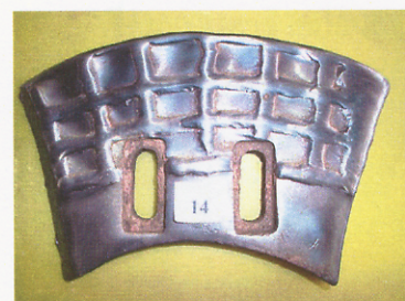
ภาคผนวก ง 8 ใบผสมดินเชื่อมพอกแข็งลายแนวเชื่อมแบบตาข่ายหลังการใช้งาน (ผลิตอิฐดินเผาได้ 3,888,000 ก้อน)
