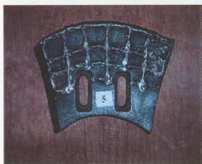
ภาคผนวก ง 13 ใบผสมดินเชื่อมพอกแข็งด้วยลวดเชื่อม E6-UM-55 (ผลิตภัณฑ์ A) ลายแนวเชื่อมแบบตาข่ายก่อนการใช้งาน
