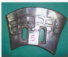
ภาคผนวก ง 14 ใบผสมดินเชื่อมพอกแข็งด้วยลวดเชื่อม E6-UM-55 (ผลิตภัณฑ์ A) ลายแนว เชื่อมแบบตาข่ายหลังการใช้งาน (ผลิตอิฐดินเผาได้ 3,888,000 ก้อน)
