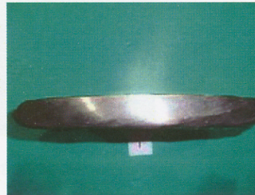
ภาคผนวก ง 12 ไบผสมดินเชื่อมพอกแข็งด้วยลวดเชื่อม E6-UM-60 (ผลิตภัณฑ์ B) ลายแนวเชื่อม แบบตาข่ายหลังการใช้งาน (ผลิตอิฐดินเผาได้ 3,888,000 ก้อน)
