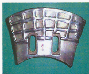
ภาคผนวก ง 16 ใบผสมดินเชื่อมพอกแข็งด้วยลวดเชื่อม E10-UM-65 (ผลิตภัณฑ์ B) ลายแนว เชื่อมแบบตาข่ายหลังการใช้งาน (ผลิตอิฐดินเผาได้ 3,888,000 ก้อน)
