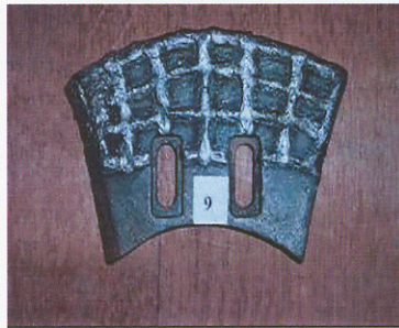
ภาคผนวก ง 11 ไบผสมดินเชื่อมพอกแข็งด้วยลวดเชื่อม E6-UM-60 (ผลิตภัณฑ์ B) ลายแนว เชื่อมแบบตาข่ายก่อนการใช้งาน
