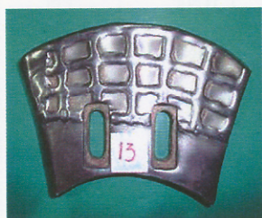
ภาคผนวก ง 18 ไบผสมดินเชื่อมพอกแข็งด้วยลวดเชื่อม E10-UM-65 (ผลิตภัณฑ์ A) ลายแนว เชื่อมแบบตาข่ายหลังการใช้งาน (ผลิตอิฐดินเผาได้ 3,888,000 ก้อน)
