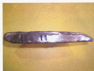
ภาคผนวก ง 8 ใบผสมดินเชื่อมพอกแข็งลายแนวเชื่อมแบบตาข่ายหลังการใช้งาน (ผลิตอิฐดินเผาได้ 3,888,000 ก้อน)
