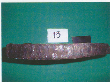
ภาคผนวก ง 5 ใบผสมดินเชื่อมพอกแข็งลายแนวเชื่อมแบบวงกลมก่อนการใช้งาน
