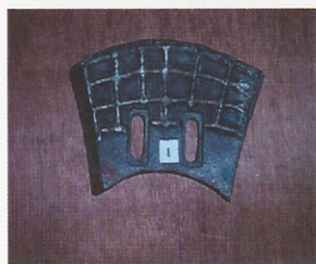
ภาคผนวก ง 15 ใบผสมดินเชื่อมพอกแข็งด้วยลวดเชื่อม E10-UM-65 (ผลิตภัณฑ์ B) ลายแนวเชื่อมแบบตาข่ายก่อนการใช้งาน
