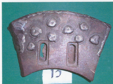
ภาคผนวก ง 5 ใบผสมดินเชื่อมพอกแข็งลายแนวเชื่อมแบบวงกลมก่อนการใช้งาน
