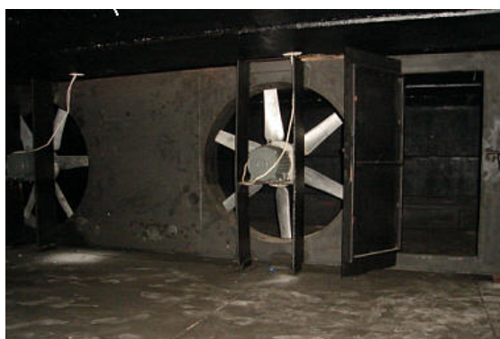
ภาพประกอบที่ 2.4 ส่วนบนของเตาอบ (เป็นส่วนของชุดพัสดมกับท่อความร้อน)
