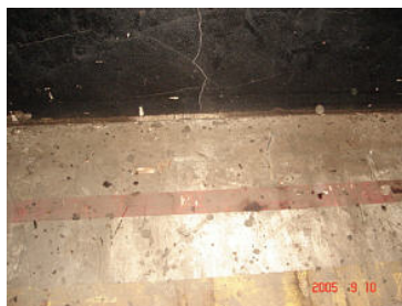
ภาพประกอบที่ 4.28 ลักษณะของเส้นในเตาอบช่วยในการจัดวางเรียงไม้ในเตา
