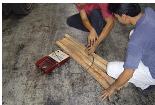
ภาพประกอบที่ 4.12 การตอกเข็มตรวจสอบความชื้นของไม้
