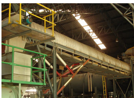
ภาพประกอบที่ 4.31 ส่วนลำเลียงจี้เลื่อยป้อนสู่ห้องเผาไหม้
