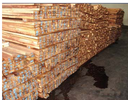
ภาพประกอบที่ 4.5 ไม้ที่รอการจัดเรียงหลังจากนำออกมาจากถังอัดน้ำยา
