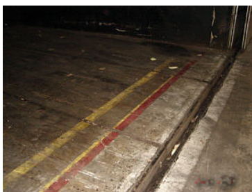
ภาพประกอบที่ 4.28 ลักษณะของเส้นในเตาอบช่วยในการจัดวางเรียงไม้ในเตา
