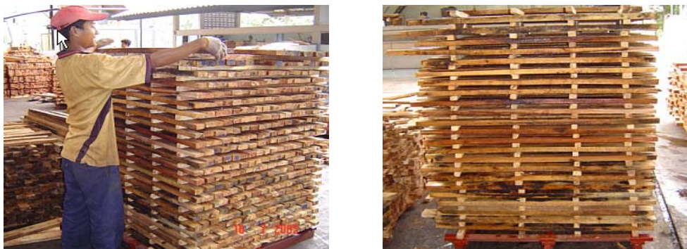
ภาพประกอบที่ 4.25 ลักษณะการจัดเรียงไม้ที่ดี
