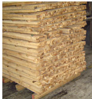
ภาพประกอบที่ 4.51 การจัดเรียงกองไม้บนพาเลตหรือไม้รองที่ทำด้วยไม้
