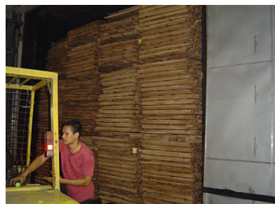
ภาพประกอบที่ 4.10 การเปิดเตาเพื่อนำไม้ออกจากเตา
