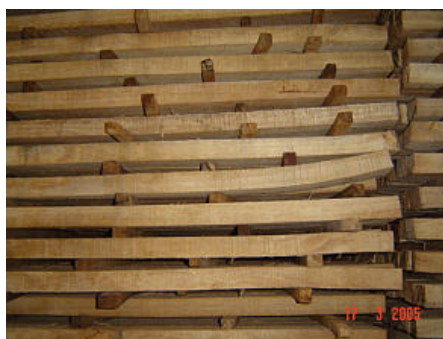
ภาพประกอบที่ 4.8 ลักษณะของไม้ที่เกิดการบิด โค้ง งอ จากการเรียงไม้คั่นที่ไม่เป็นแนวเดียวกัน
