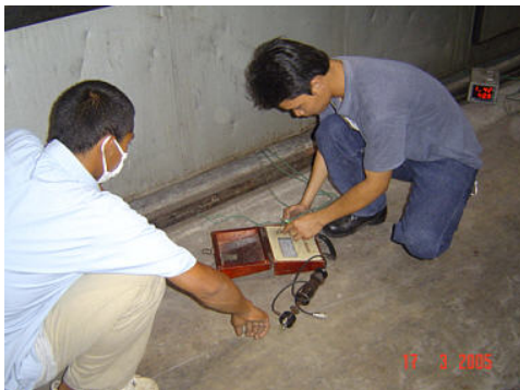
ภาพประกอบที่ 4.17 การตรวจสอบค่าความชื้นแบบใช้สายวัด
