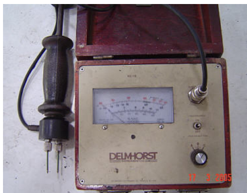
ภาพประกอบที่ 4.13 เครื่องมือตรวจสอบค่าความชื้นของไม้ แบบ Resistance-type
