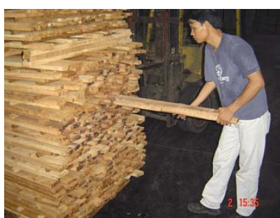
ภาพประกอบที่ 4.11 การสุ่มไม้ออกจากกองเพื่อนำออกมาตรวจสอบค่าความชื้น
