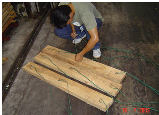
ภาพประกอบที่ 4.15 การตอกเข็มและพันสายไม้ทดลอง
