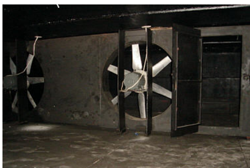
ภาพประกอบที่ 4.29 ส่วนบนของเตาอบ (ส่วนของชุดพัดลมกับท่อความร้อน)
