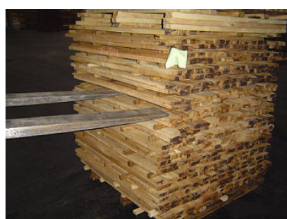
ภาพประกอบที่ 4.11 การสุ่มไม้ออกจากกองเพื่อนำออกมาตรวจสอบค่าความชื้น
