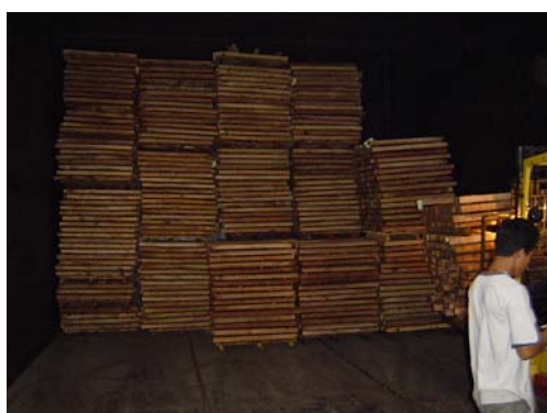
ภาพประกอบที่ 4.9 การนำไม้เข้าเตาอบ
