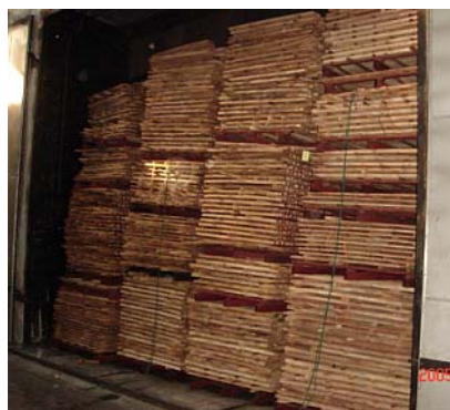
ภาพประกอบที่ 4.16 การนำไม้ตัวอย่างไปวางในเตาอบ
