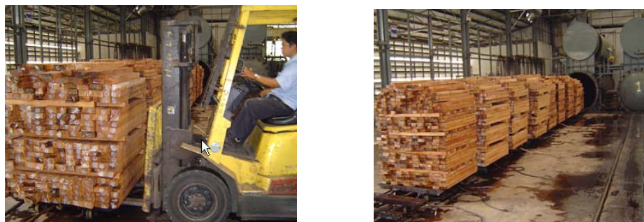
ภาพประกอบที่ 4.4 การนำไม้เข้าถังอัดน้ำยา
