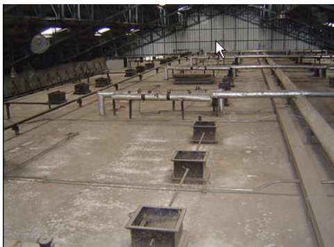
ภาพประกอบที่ 4.45 ช่องระบายความชื้น ด้านบนเตาอบ
