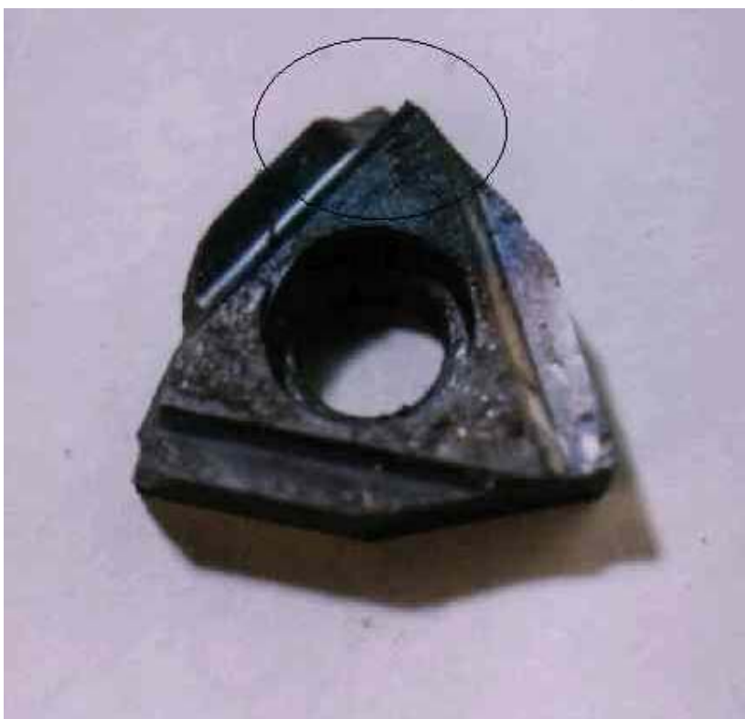
ภาพประกอบ 4.22 ไบมีดภายหลังทดลอง การทดลองชุดที่ 3
