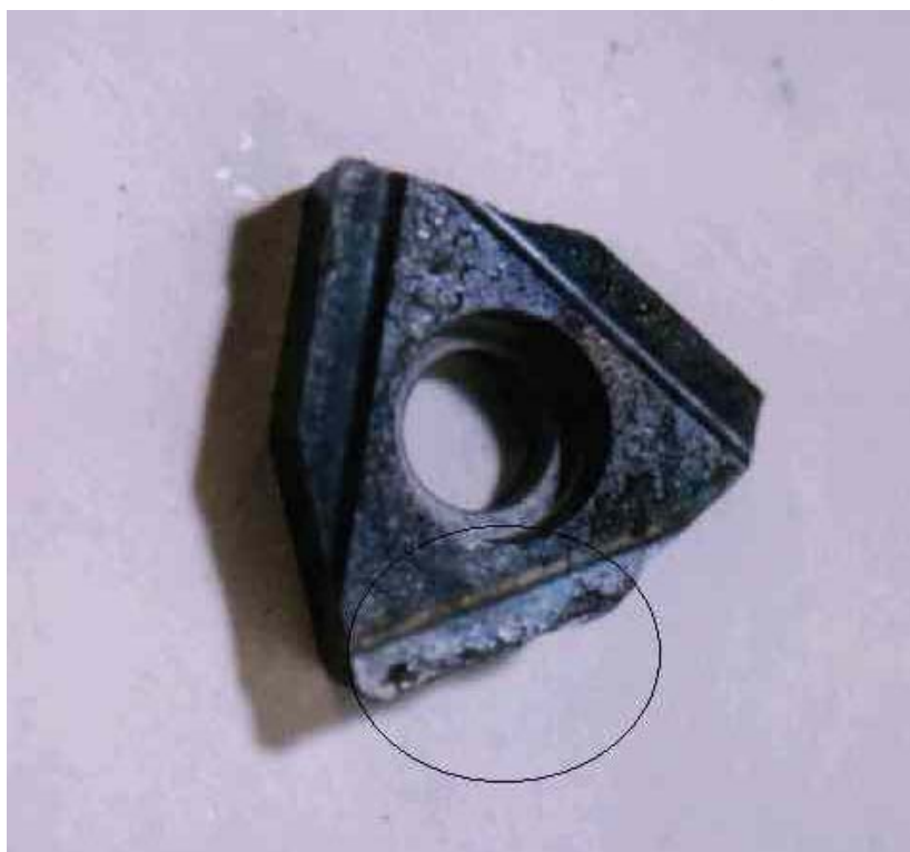
ภาพประกอบ 4.21 ไบมีดภายหลังทดลอง การทดลองชุดที่ 2
