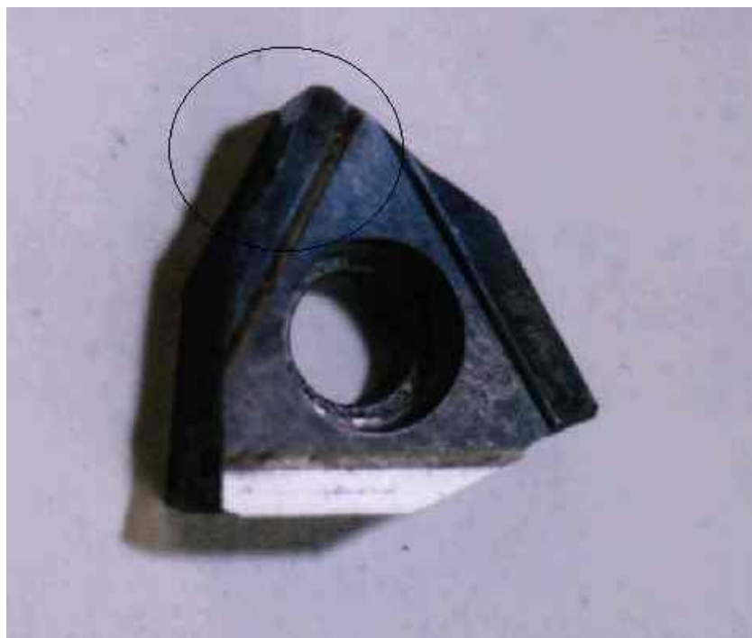
ภาพประกอบ 4.20 ไบมีดภายหลังทดลอง การทดลองชุดที่ 1
