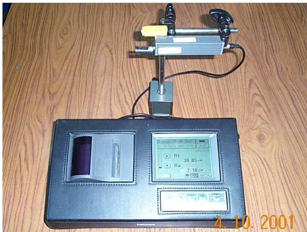
ภาพประกอบ 4.14 เครื่องวัดความขรุขระของพื้นผิว
