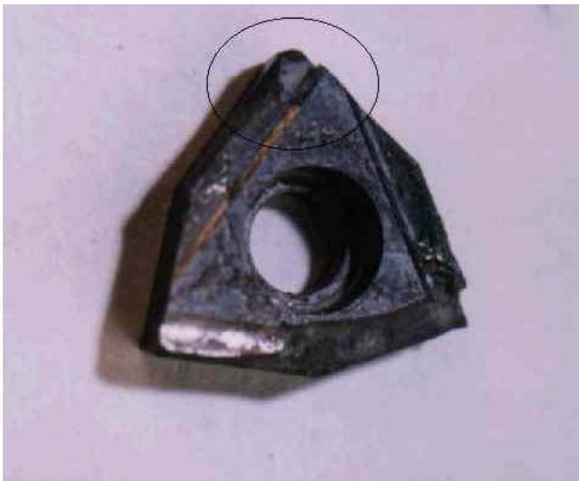
ภาพประกอบ 4.22 ไบมีดภายหลังทดลอง การทดลองชุดที่ 3
