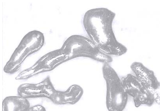
รูปที่ 4.53 ผงโลหะดีบุกผสมตะกั่ว 39 % ขนาด - 74 \mu\text{m} (100 x) มีรูปร่างแบบ Ligamental และ Tear drop ปะปนกัน
