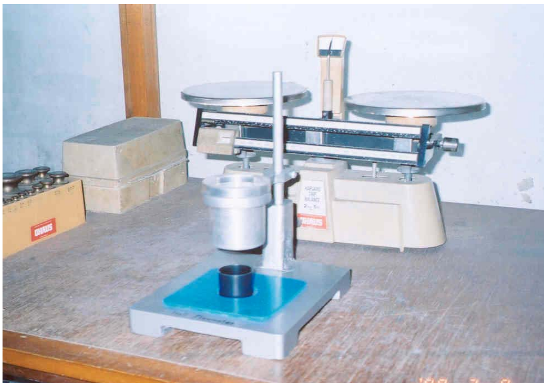
รูปที่ 4.89 Hall flowmeter ที่สร้างขึ้นตามมาตรฐาน ASTM B 212
