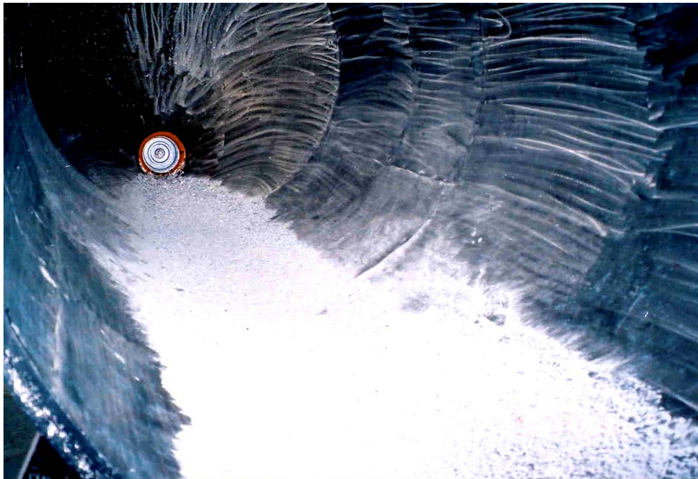
รูปที่ 4.1 ผงโลหะอะลูมิเนียมซึ่งได้จากการผลิต ที่อยู่ภายในห้องฟนโลหะเหลว ก่อนการนำมาทำการคัดแยกขนาดด้วยชุดตะแกรงมาตรฐาน
