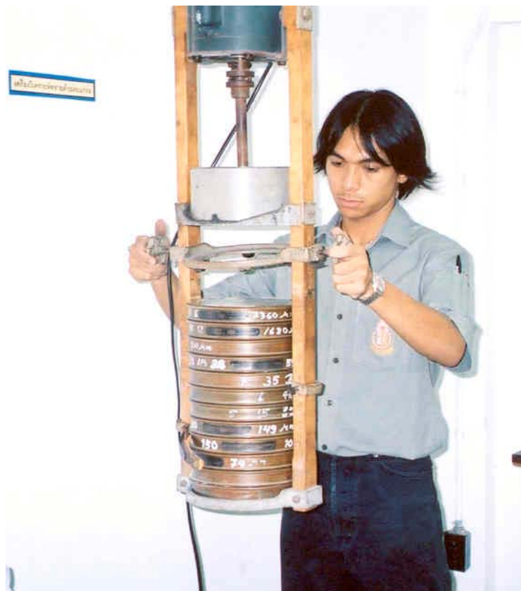
รูปที่ 4.43 ชุดตะแกรงมาตรฐานที่ใช้ในการคัดแยกขนาดผงโลหะชนิดต่าง ๆ
