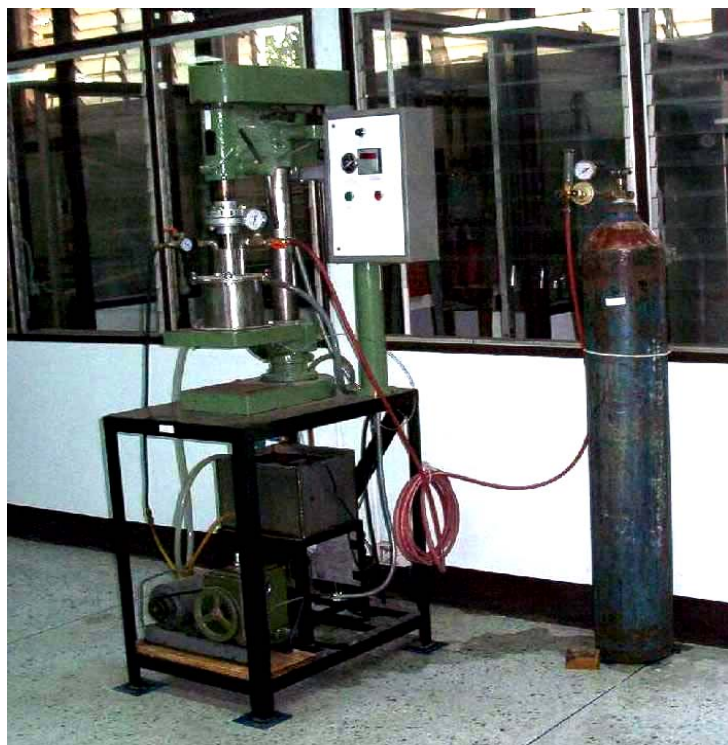
รูปที่ 2.6 เครื่องบดแอทไตรเตอร์ที่สร้างเสร็จเรียบร้อยแล้ว
