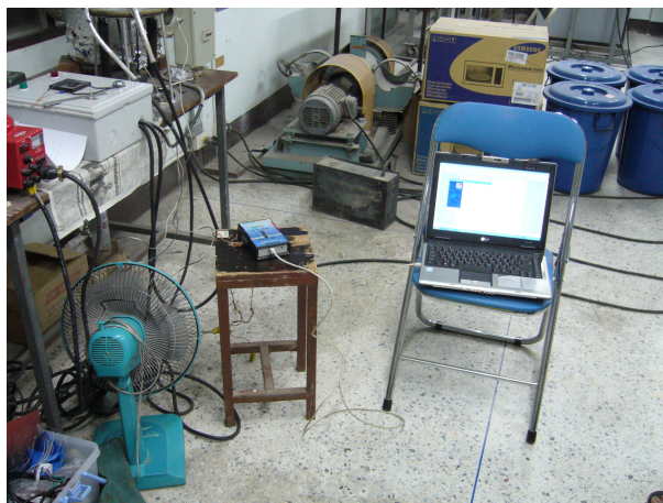
รูปที่ 2.10 แสดงอุปกรณ์ USB Data Acquisition ต่อเข้ากับคอมพิวเตอร์
