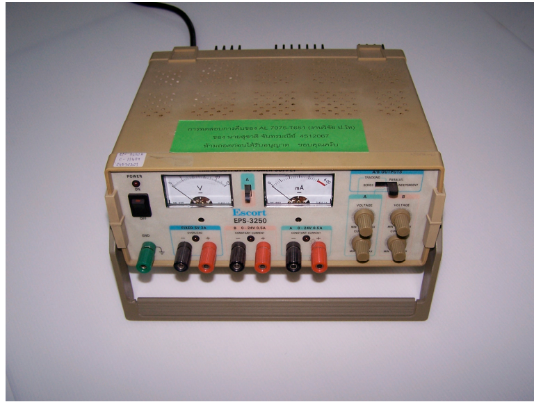
รูปที่ ผค.5 แหล่งจ่ายไฟปรับค่าได้ 3 ช่อง (Triple Output DC Supply) รุ่น EPS 3250A
