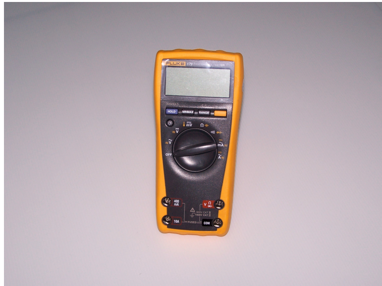
รูปที่ ผค. 7 Digital Multimeter “FLUKE” รุ่น 179 ชั่ง วงอุณหภูมิตั้ง 40°C ถึง 400°C
