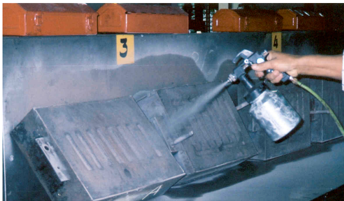
รูปที่4.3 แบบหล่อทรายที่ใช้ในการหล่อชิ้นงานทดสอบในงานวิจัยนี้
