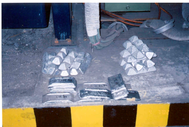
รูปที่ 4.1 การเตรียมวัตถุดิบก่อนทำการผสมประกอบด้วย Ingot ที่หลอมจากกระป๋องและ Master Alloy แบบแผ่น
