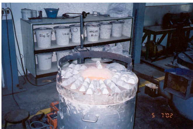
รูปที่ 4.2 การ Preheat วัตถุดิบก่อนใส่ในเบ้าหลอมเพื่อไล่ความชื้น
