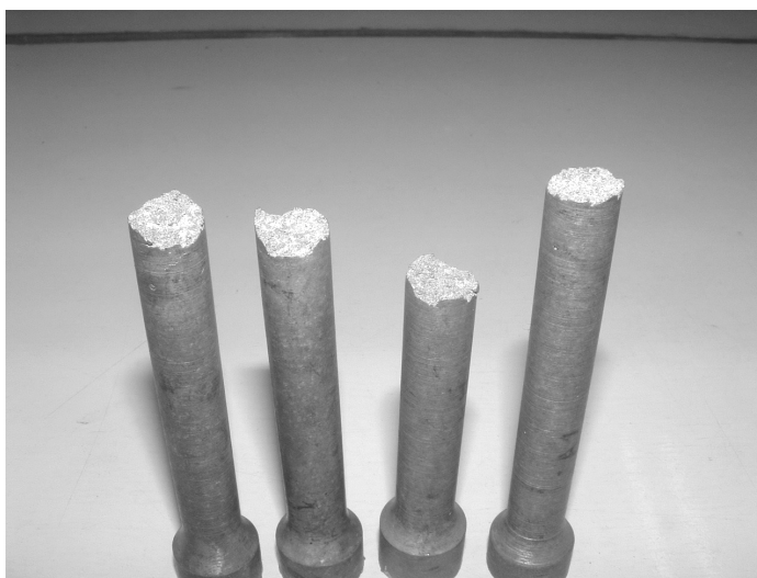
รูปที่ 5.8 ลักษณะการวิบัติของชิ้นงานทดสอบแรงดึง A356
