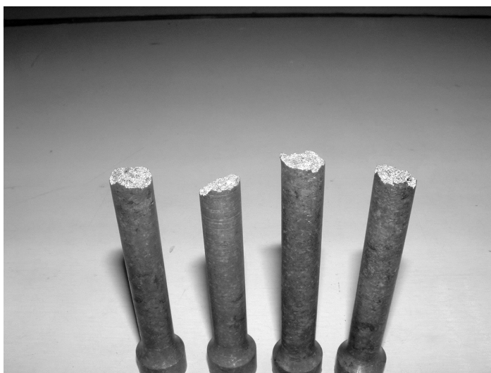
รูปที่ 5.7 ลักษณะการวิบัติของชิ้นงานทดสอบแรงดึง A1-7%Si
