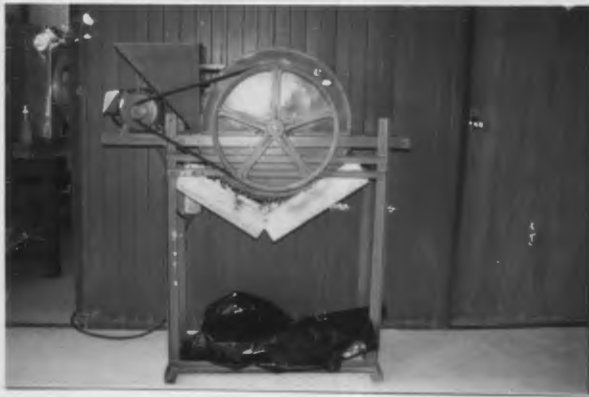
รูปที่ 4 เครื่องแยกเปลือกยางออกจากเส้นข้าว
