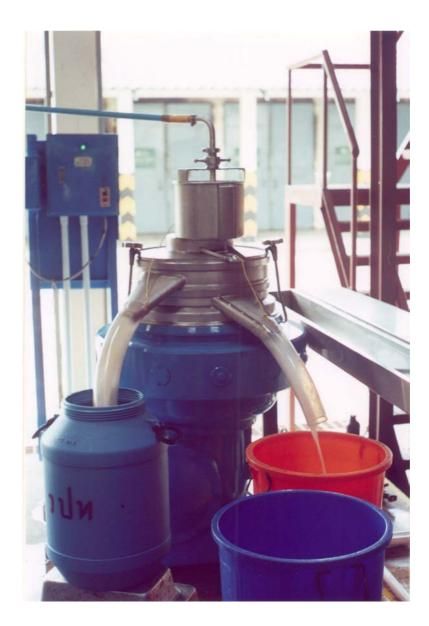
Fig. 13 de Larval centrifuge (type 410A-79M/3786).
