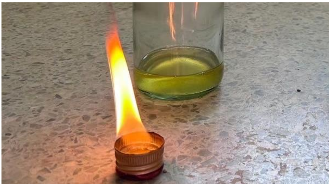
ภาพที่ 4.4 คุณลักษณะภายนอกของน้ำมันเชื้อเพลิงที่ได้จากเตาเผาขยะพลาสติก
