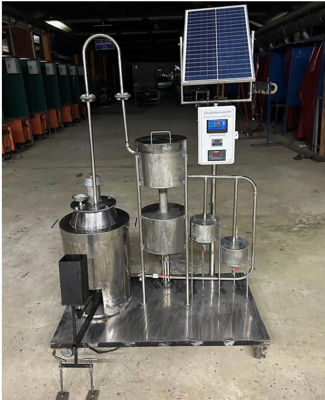
ภาพที่ 4.2 เตาเผาขยะพลาสติกให้เป็นน้ำมันเชื้อเพลิงขนาดจริง
