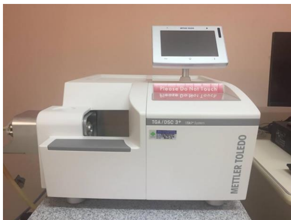
รูปที่ 3.5 เครื่องวิเคราะห์การสลายตัวทางความร้อน
