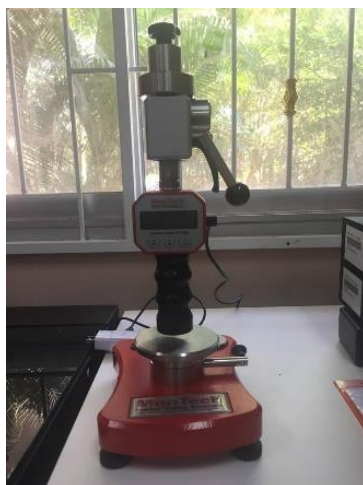
รูปที่ 3.7 เครื่องวัดความแข็งแบบ Durometer
