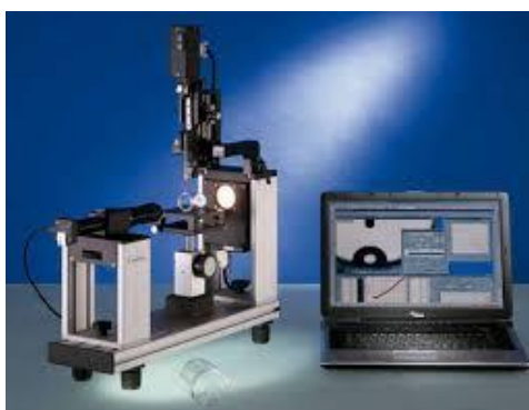
รูปที่ 3.9 เครื่องวิเคราะห์หามุมสัมผัส
