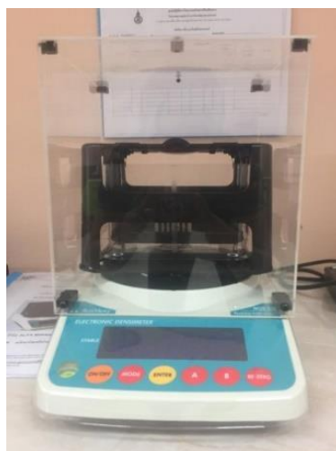
รูปที่ 3.8 เครื่องวัดความถ่วงจำเพาะ
