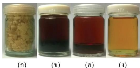
รูปที่ 5 แสดงวัตถุดิบและผลิตภัณฑ์ของกระบวนการผลิตเอทิลเอสเทอร์ด้วยปฏิกิริยาเอสเตอร์ฟิเคชันแบบสองขั้นตอน (ก) กรดไขมันปาล์มที่อุณหภูมิ 30^{\circ}\text{C} (ข) น้ำมันลดกรดไขมันอิสระขั้นตอนที่ 1 [ชั้นบนคือน้ำมันลดกรดไขมันอิสระขั้นตอนที่ 1, ชั้นล่างคือน้ำ] (ค) ไบโอดีเซลดิบ [ชั้นบนคือเอทิลเอสเทอร์, ชั้นล่างคือน้ำ] และ (ง) ไบโอดีเซลบริสุทธิ์จากกรดไขมันปาล์ม
