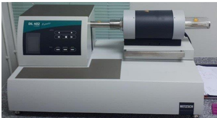
รูปที่ 3.5 เครื่องมือที่ใช้ในการทดสอบสมบัติทางความร้อน ไดลาโตมิเตอร์ (Dilatometer)
