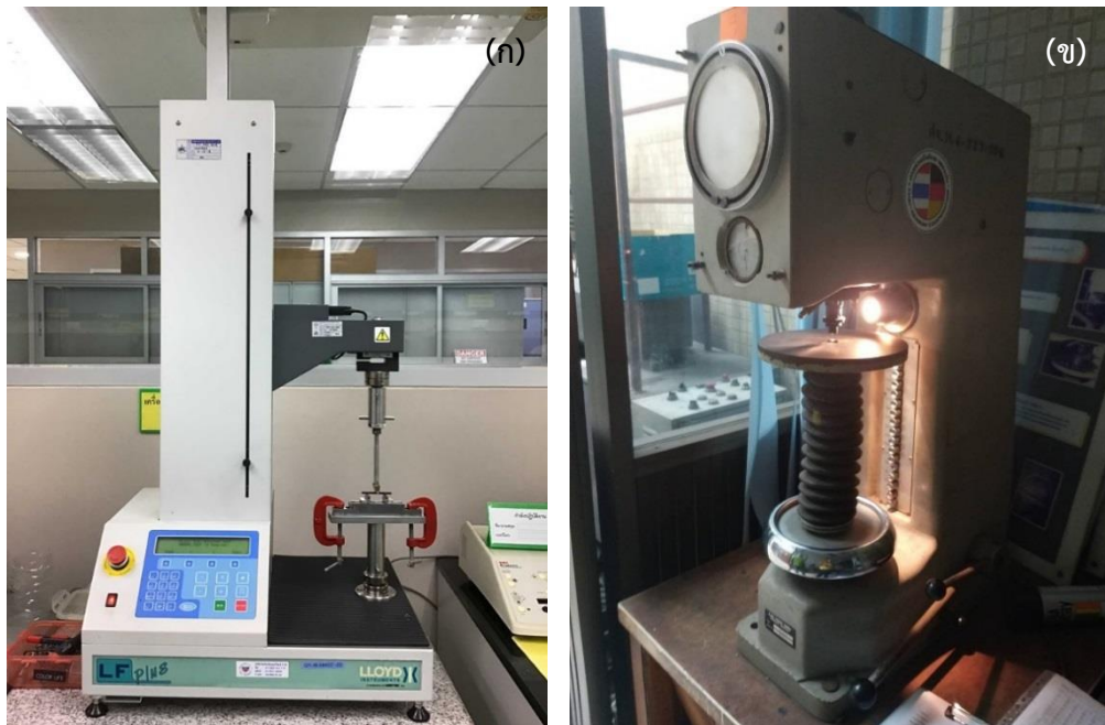
รูปที่ 3.4 เครื่องมือที่ใช้ในการทดสอบสมบัติเชิงกล (ก) เครื่องมือทดสอบความแข็งแรงต่อการดัดโค้ง และ (ข) เครื่องมือทดสอบความแข็งแรงแบบวิกเกอร์
