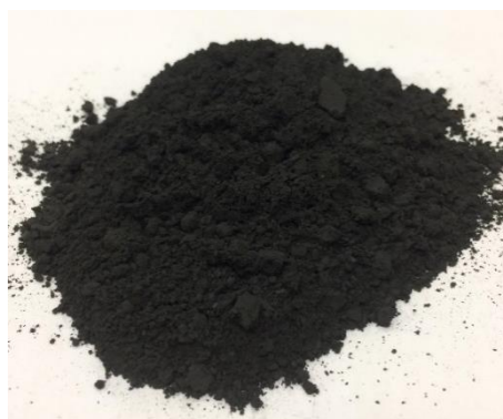
รูปที่ 3.12 ผงสารผลิตภัณฑ์ที่ได้หลังจากคัดขนาด <45 \mu m
