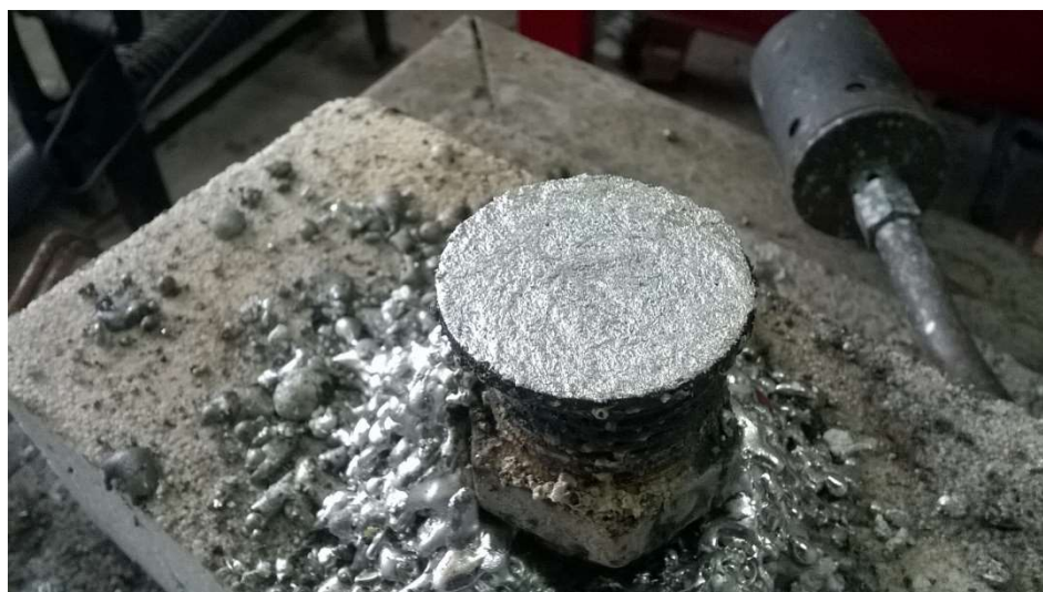
รูปที่ 3.17 ผิวหน้างานอะตอมไมเซอร์ที่ถูกเคลือบด้วยโลหะบัดกรีไร้สารตะกั่วชนิด SAC305
