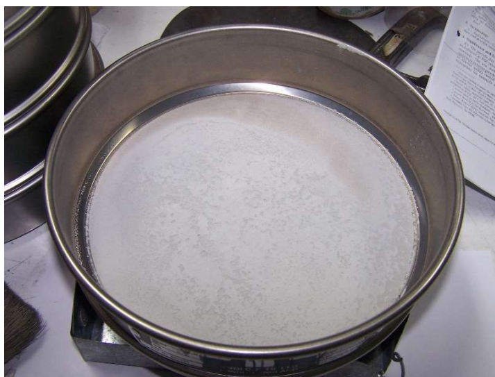
รูปที่ 4.6 การร่อนผงโลหะขนาดละเอียดในตะแกรงร่อน
