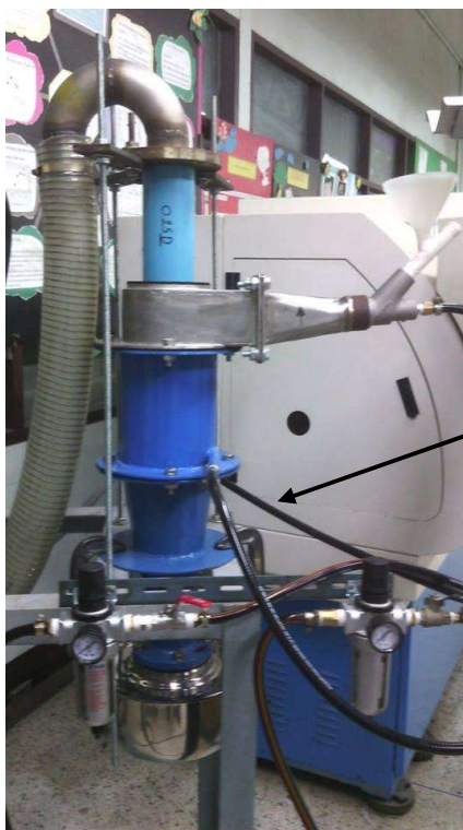
รูปที่ 3.23 เครื่องคัดขนาดไซโคลนลมต้นแบบที่ติดตั้งระบบลมเสริม
