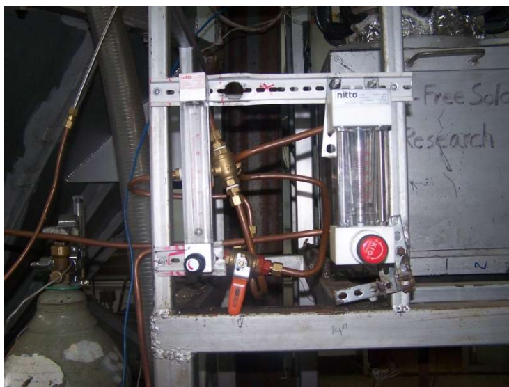
รูปที่ 3.16 อุปกรณ์สำหรับวัดอัตราการไหลและควบคุมปริมาณก๊าซไนโตรเจน
