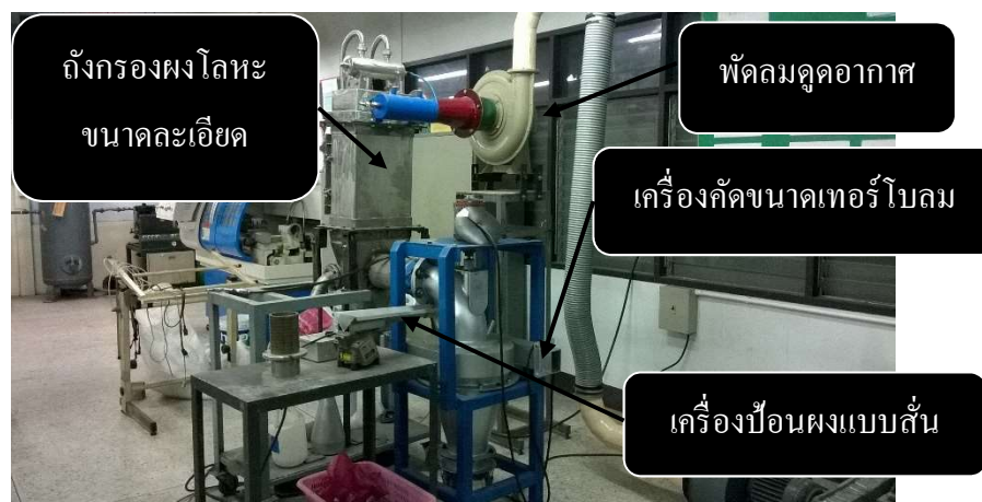
รูปที่ 3.26 เครื่องคัดขนาดเทอร์โบลมที่ติดตั้งอุปกรณ์ต่าง ๆ เข้าด้วยกันแล้ว
