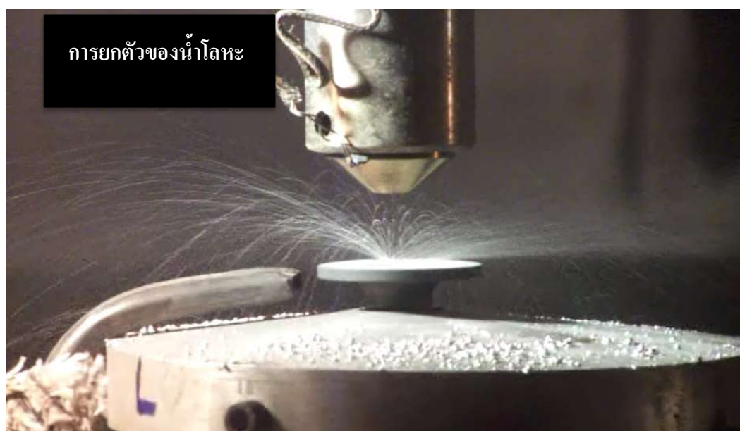
รูปที่ 4.1 ปรัชการณยกตัวของน้ำโลหะ ในช่วงเริ่มการอะตอมไมเซชัน จากการทดลองที่ความเร็วรอบ 50,000 รอบต่อนาที อัตราการป้อน 50 กิโลกรัมต่อชั่วโมง
