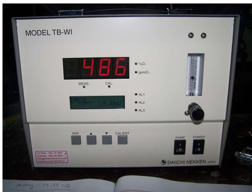
รูปที่ 3.2 เครื่องตรวจวัดปริมาณออกซิเจนที่อยู่ภายนอกถังอะตอมไมเซอร์
