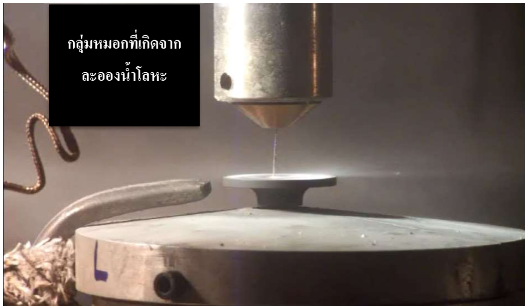
รูปที่ 4.2 ปรากฏการณ์น้ำโลหะแตกตัวเป็นละอองน้ำโลหะขนาดเล็ก เมื่อเข้าสู่สภาวะสมดุล จากการทดลองที่ความเร็วรอบ 50,000 รอบต่อนาที อัตราการป้อน 50 กิโลกรัมต่อชั่วโมง
