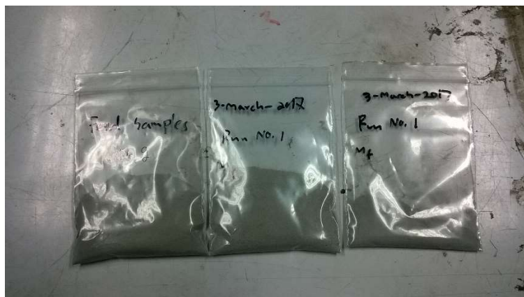
รูปที่ 3.28 ผงโลหะที่เตรียมสำหรับส่งตรวจวิเคราะห์ขนาด (ซ้าย) ผงป้อน (กลาง) ผงหยาบ และ (ขวา) และผงละเอียด
